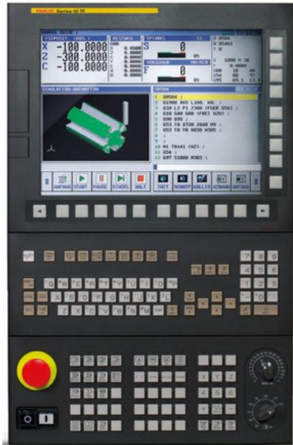
Reduzieren Sie den Zeitaufwand bei der Überführung Ihrer Zeichnungen in die Produktion: Mit dem FANUC MANUAL GUIDE i lassen sich sowohl einfache als auch hoch komplizierte Maschinentypen inklusive Dreh-, Fräs-, Bohr- und Mess - zyklen schnell und einfach umsetzen. Dabei unterstützt die Software Sie durch intuitive interaktive Benutzerführung sowie spezielle Funktionen zur einfachen Teileprogrammierung und Simulation.
