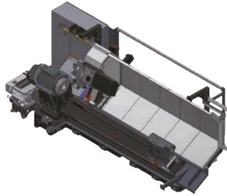
Massive Gussbettkonstruktion für stabile Fertigungsprozesse. Die um 30° geneigten Flachführungen gewährleisten einen optimalen Spanabfluss. Das Gussbett ist auf maximale Stabilität und Vibrationsdämpfung ausgelegt. Die gehärteten Flachführungen sind auf eine lange Lebensdauer optimiert.
