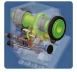
Durch die gleichzeitige Entwicklung der Hauptspindel und des Getriebes wurde die Kühleffizienz sowohl der Hauptspindel als auch des Getriebes verbessert. Die Gurtstruktur wurde durch die Vereinheitlichung des Getriebes mit der Hauptspindel vereinfacht, wodurch die durch den Gurt verursachten Vibrationen und Geräusche reduziert wurden.
