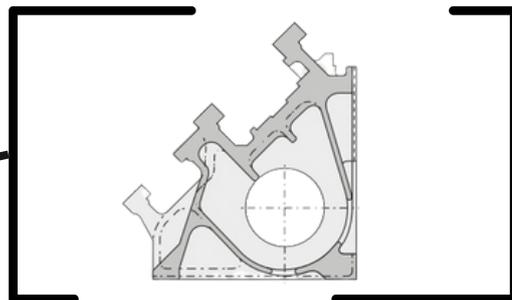
Das 45-Grad-Schrägmoment-Rohr-Designbett und der breite Führungsgleitweg garantieren langfristige Steifigkeit und hohe Bearbeitungsgenauigkeit. Darüber hinaus erleichtert die Schräge-Bauweise den Zugang zum Werkstück und gewährleistet eine hervorragende Spanabfuhr.
