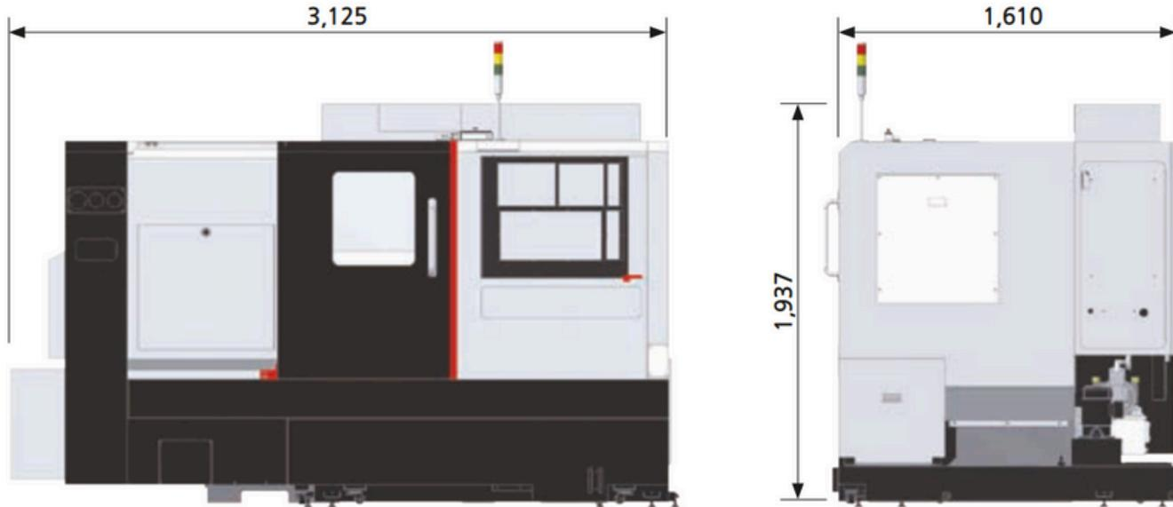
Länge mit Späneförderer (seitlich montiert) 4230mm
