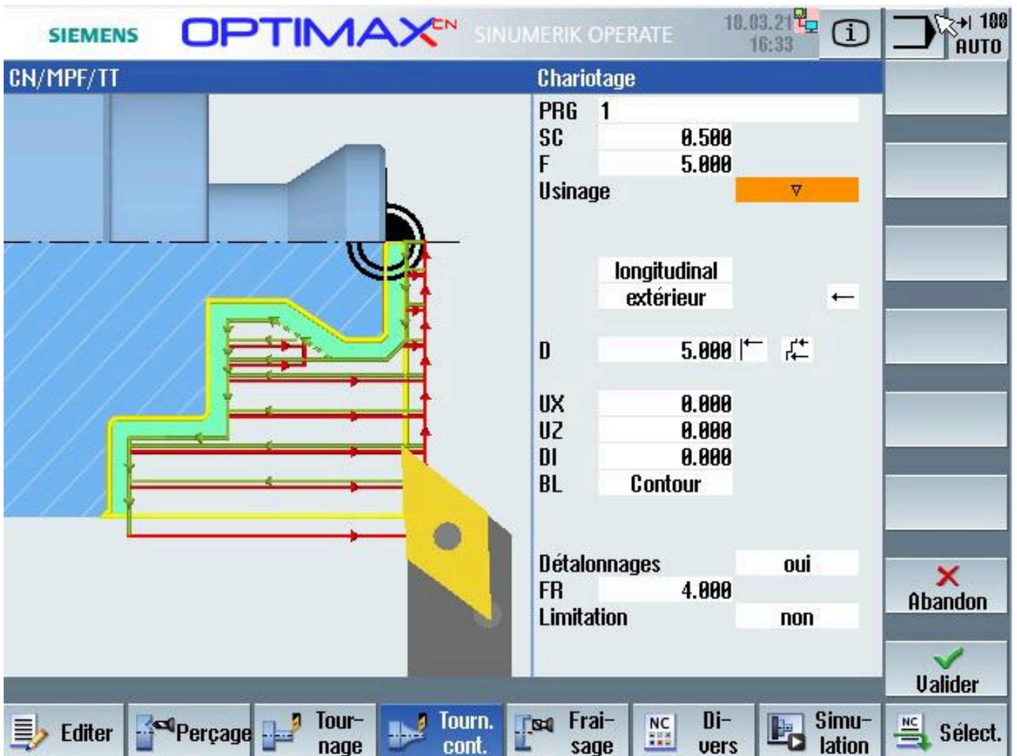
SIEMENS OPTIMAX<sup>CN</sup> SINUMERIK OPERATE 10.03.21 16:33
